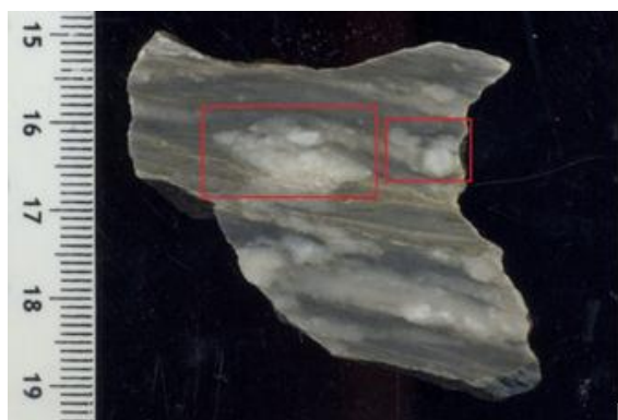
Figura 11: Amostra 11-PGL-32. Bolsões e grânulos milimétricos de calcita recristalizada. Escala em centímetros.
