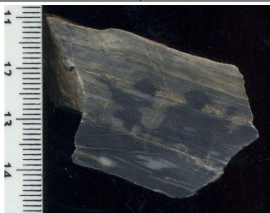
Figura 13: Amostra 11-PGL-10. Detalhe para manchas escuras, podendo se tratar de manchas de óleo. Escala em centímetros.
