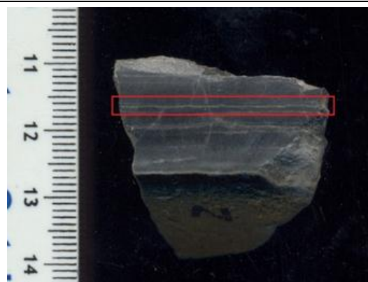
Figura 12: Amostra 11-PGL-02. Detalhe para estilólito, estrutura mesodiagenética comum em calcários. Escala em centímetros.
