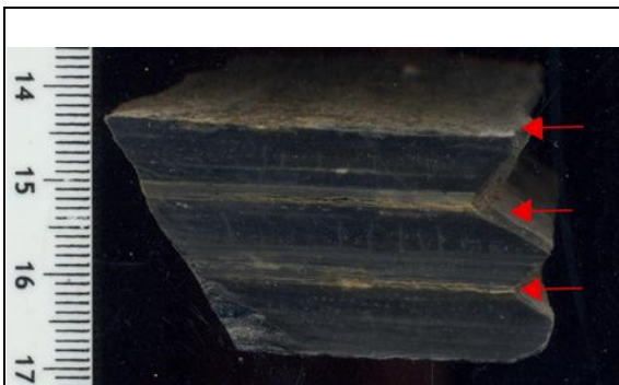
Figura 9: Amostra 11-PGL-20. Detalhe para lâminas submilimétricas compostas por micas, marcando planos de fraqueza no calcário. Escala em centímetros.
