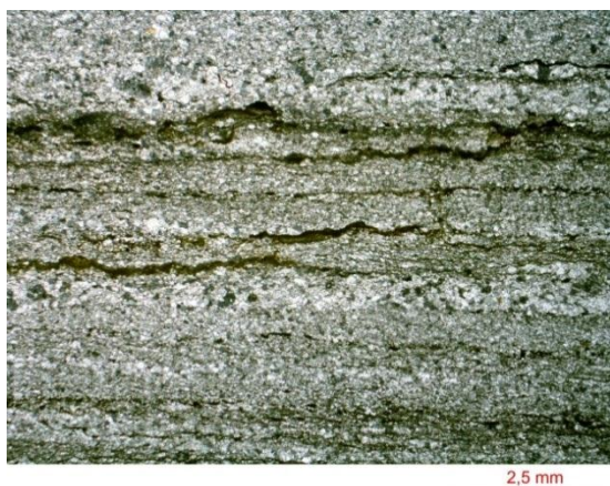
Figura 24: Amostra 11-PGL-20. Calcissiltito médio, intercalado com calciarenito muito fino, com lâminas ricas em minerais opacos e argilominerais. Polarizadores cruzados.
