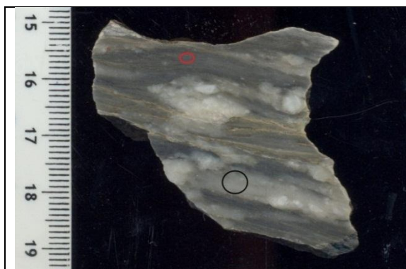
Figura 41: Amostra 11-PGL-32, o círculo preto corresponde à porção recrystalizada da amostra e o círculo vermelho à porção isenta de recrystalizações. A composição isotópica entre elas pouco varia. Escala em centímetros.
